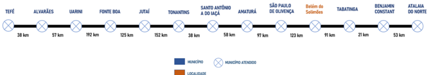
Figura 2: Diagrama da rede física da infovia 02
